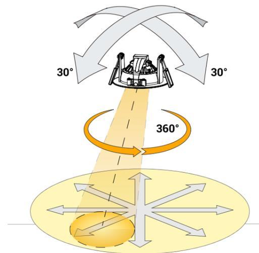
Die Rebekka 80 ist kardanisch verstellbar, ohne dass die Leuchte demontiert werden muss.
