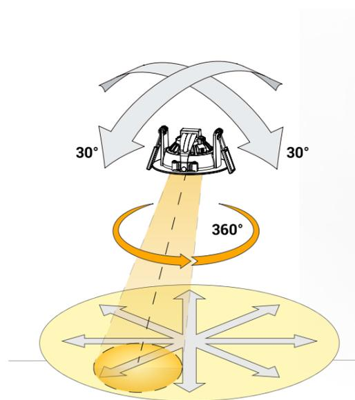
Die **SARA** ist kardinal verstellbar, ohne dass die Leuchte demontiert werden muss.
